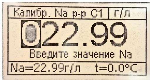
Рис. 30. Экран «Калибровка канала Na раствором»
