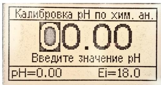
**Рис. 26. Экран «Калибровка pH по хим. анализу»**
