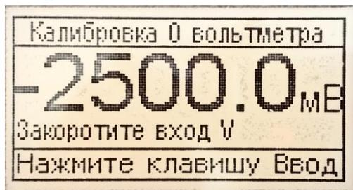
Рис. 24. Экран «Калибровка вольтметра Na/pH»
